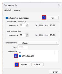
Dans la fenêtre qui s'ouvre, appuyez sur « Ajouter » en bas, puis rentrez l'adresse IP suivante « 10.92.100.100 ». Enfin, appuyez sur le bouton test en haut à droite et vous pouvez fermer la fenêtre si vous avez fini de connecter « Tournament Planner » à la solution.
